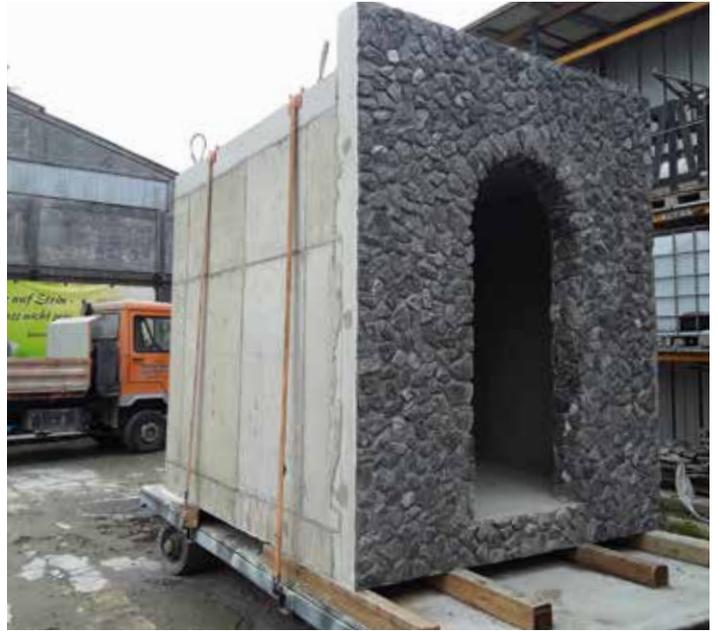
Fertigkeller mit Frontplatte Starwalls Gneiss
